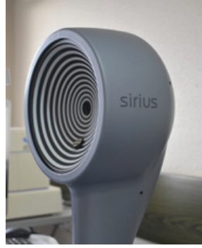
Şekil 8. Scheimpflug kamera ile büyük kon Placido disk birleştirilerek hem yükseklik haritası hem de keratometri haritası tekrarlanabilir bir şekilde elde edilebilmektedir (Sirius, CSO).
