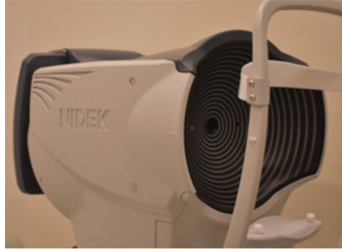
Şekil 4. Büyük kon Placido temelli topografi cihazları aberometri ile birleştirilerek korneanın aberasyonlarının gözün toplam aberasyonlarından ayrılmasını sağlayabilir ve tekrarlanabilir yakın ve uzak refraksiyon ölçümleri alabilir (OPD III, Nidek).
